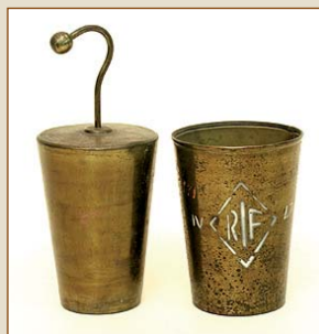
Bottiglia di Leida - Condensatore elettrico ad armature mobili in ottone, databile agli inizi del XIX secolo. Proviene dall'Istituto Fisico della Regia Università di Roma
