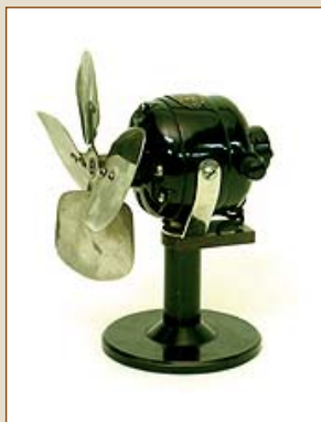
Ventilatore da laboratorio - Destinato a raffreddare apparati soggetti a surriscaldamento, in genere resistori elettrici
