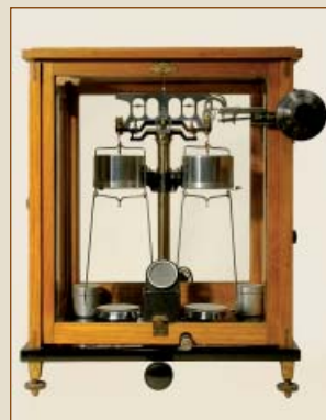
Bilancia analitica - Bilancia Sartorius per pesate rapide realizzata nelle officine Galileo-Sartorius di Firenze
